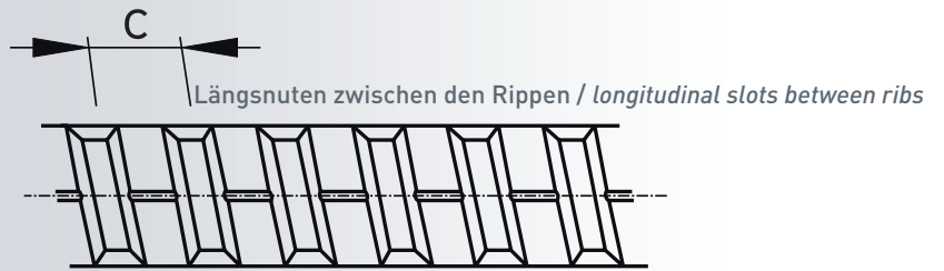
SAS 900 / 1100 – Type FA warmgewalzt, schweißbar / hot rolled, weldable
